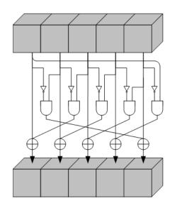
$\chi_{i}(x, y, z) = \chi_{o}(x, y, z) \oplus \chi_{o}(x+1, y, z) \cdot [\chi_{o}(x-1, y, z) \oplus \chi_{o}(x+2, y, z) \oplus \chi_{o}(x-1, y, z) \cdot \chi_{o}(x+3, y, z)]$
